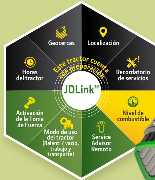
JDLink™ es el sistema que permite a los clientes controlar todo sobre sus equipos: trabajo realizado, acceder a datos importantes, analizar y optimizar el rendimiento, recibir alarmas, proporcionar asistencia remota al operador y automatizar el intercambio de datos.
